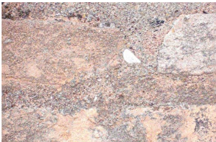
Photographie 2. Valve de Dreissène et fragments coquilliers dans un mortier.
